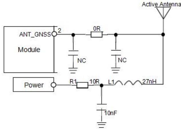
图 20: GNSS 有源天线设计
