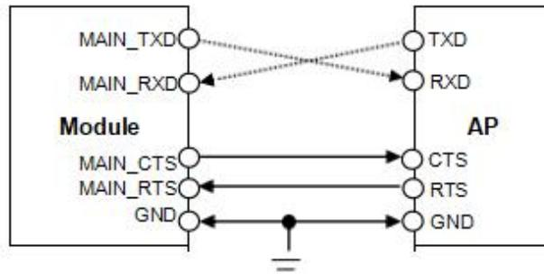
图 12: 模块串口与 AP 应用处理器 4 线接法
